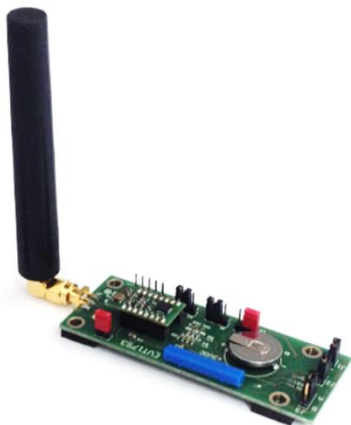
Fig.1 - Eval-board EVT17S3 with the SPT17S3-D2 and the STE n.195020 monopole quarter-wave antenna.
