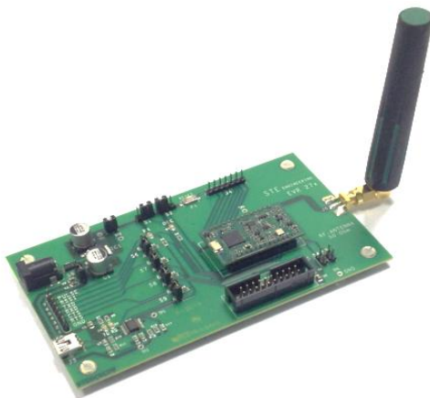
The SPR27S3-D2 receiver module and the \lambda/4 Antenna ( Ste n.195020 ) mounted on the EVR27A Eval-board
